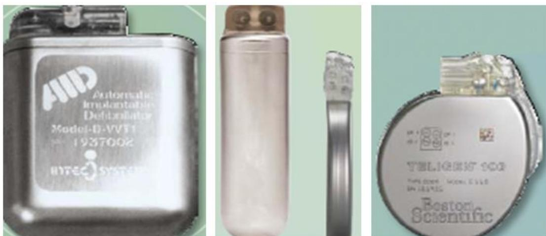
*Figura 1.4 Comparación de forma y tamaño entre el primer dispositivo que se implantó en 1980 y un dispositivo de 2008 con sólo 31,5 cc de volumen. BSC con permiso\**
